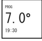
Ako je izabrana funkcija protiv smrzavanja, onda će se pri izboru ECO načina rada temperatura postaviti na  $6^{\circ}\text{C}$  (automatski se smanjuje za  $1^{\circ}\text{C}$ )
